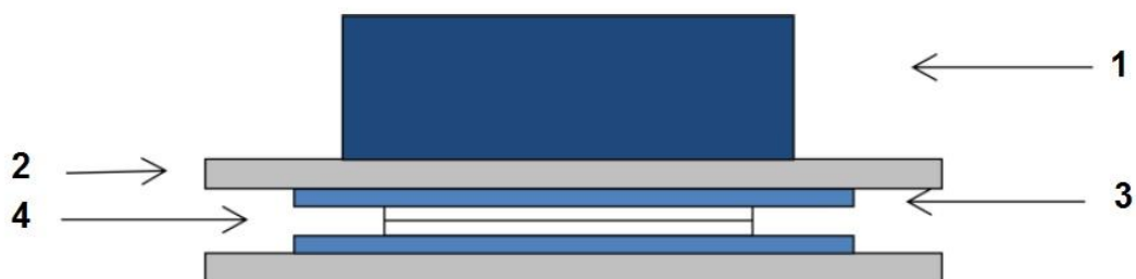
Obrázek č. 17 Schéma tepelného bondování – 1 – závaží, 2 – tepelně odolné sklo, 3 – křemíková destička, 4 – skla určená pro bondování
