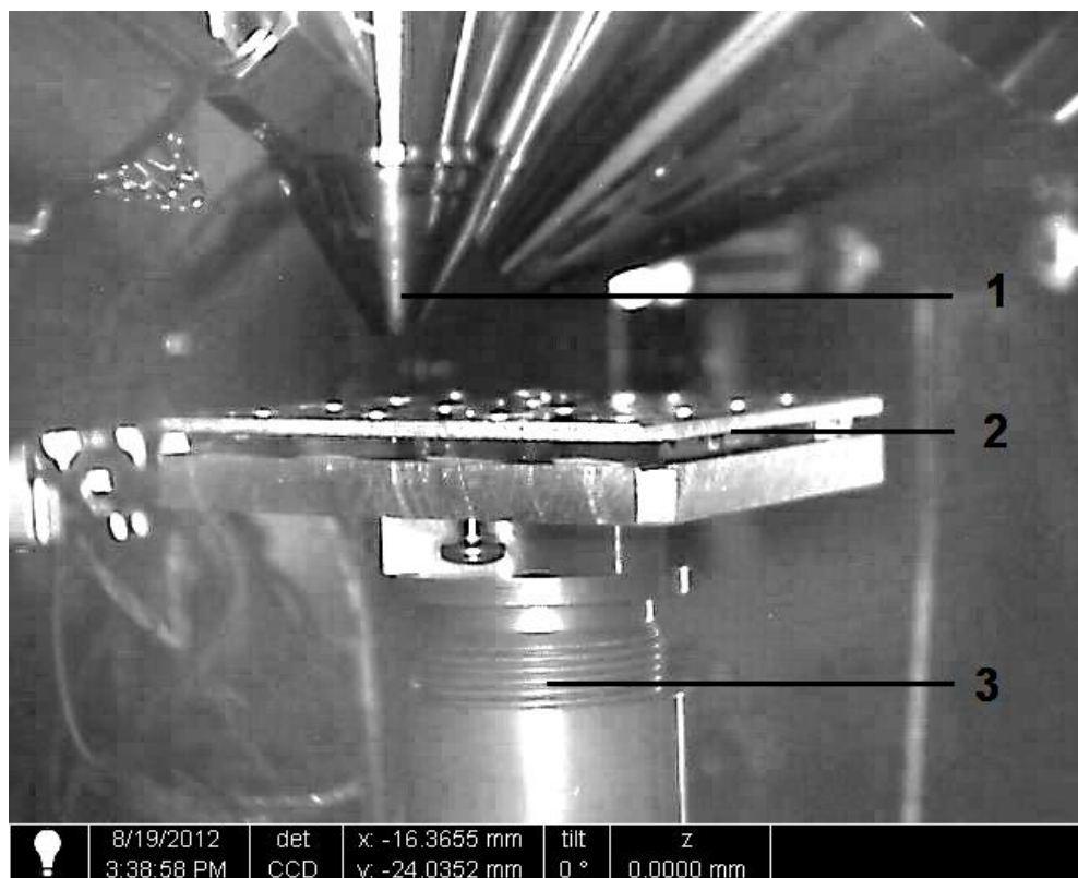
Obrázek č. 15 Experimentální trubice elektronového mikroskopu – 1 – objektiv, 2 – držák vzorků, 3 – manipulátor
